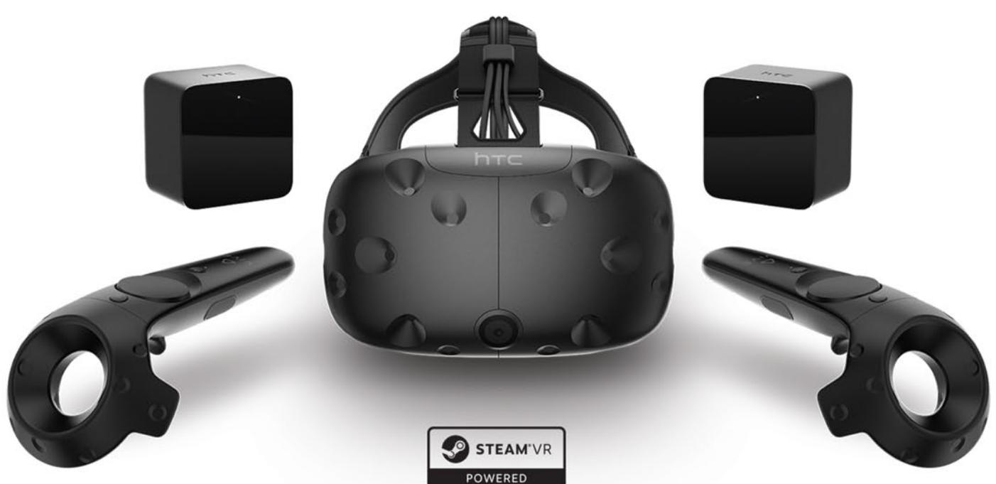
te cu trackpad, trăgaci, precum și un mecanism de feedback prin vibrații. Din headset pleacă 3 cabluri, mai precis un cablu HDMI, un cablu USB 3.0 și un cablu de alimentare, pe care le conectăm la un hub intermediar (Link Box). Acesta se alimentează la priză, iar din el conectăm la PC un cablu USB 3.0 precum și un cablu HDMI sau Display Port. Apoi...suntem gata să ne punem pe treabă.
