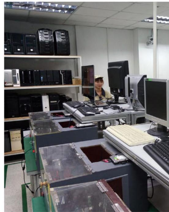
unor descărcări de electricitate statică. În ultima imagine puteți observa un inginer care „electrocutează” practic un sistem, pentru a testa modul în care componentele sunt izolate, mecanismele de protecție ale sursei s.a.m.d. În fundal puteți vedea mai multe sisteme care sunt testate
