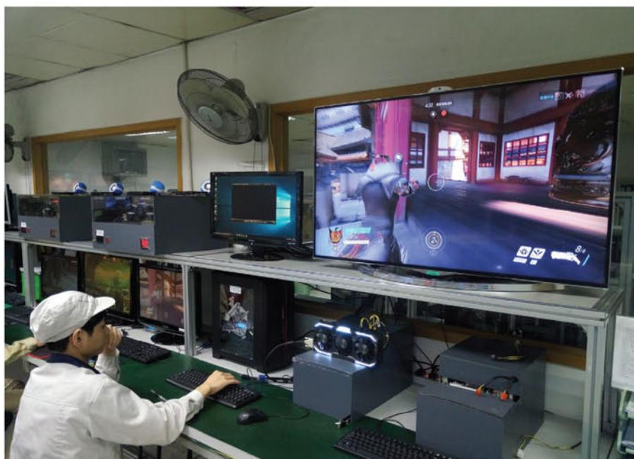
plăcile video și mini PC-urile asamblate în această fabrică sunt verificate riguros la nivelul emisiei de zgomot, tip de sunete pe care le pot produce în sarcină s.a.m.d.
